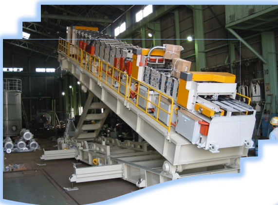
【水処理設備用コンベア】
