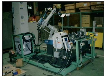
溶接口ロボットシステム
